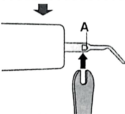
Den Schlüssel in Position A einsetzen
