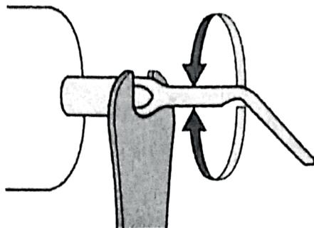
Drehen Sie den Kopf mit einem Schraubenschlüssel gegen den Uhrzeigersinn, um die Arbeitsspitze zu trennen und die Demontage abzuschließen.
