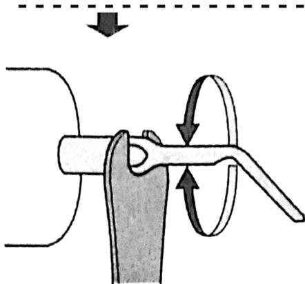
Drehen Sie den Kopf mit einem Schraubenschlüssel gegen den Uhrzeigersinn, um die Arbeitsspitze zu trennen und die Demontage abzuschließen.
