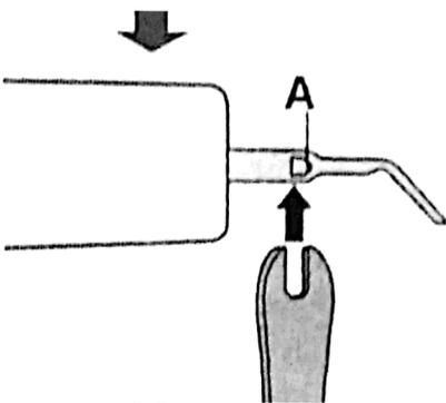
Den Schlüssel in Position A einsetzen
