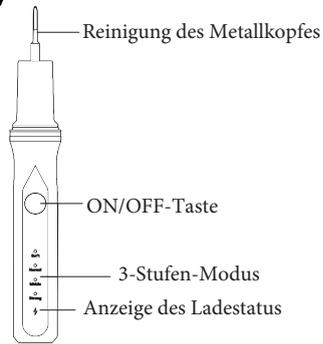
Schalten Sie das Gerät durch langes Drücken der ON-Taste ein. Nach dem Einschalten leuchtet die Kontrollleuchte grün.
