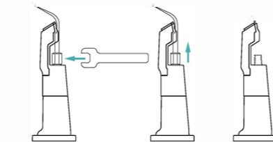
1. Lösen Sie die Matrize mit dem Schraubenschlüssel
